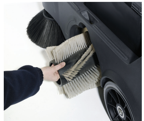
De filter en borstels zijn snel en gemakkelijk zonder gereedschap bereikbaar voor onderhoud en vervanging
